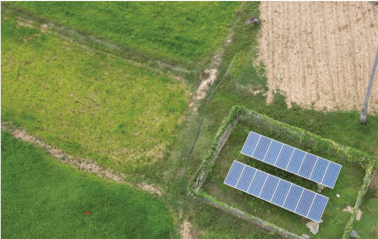
កម្ពុជាមានធនធានដែលដើរដោយថាមពលពន្លឺព្រះអាទិត្យដ៏ច្រើនក្នុងតំបន់។ ប្រព័ន្ធបូមទឹកថាមពលពន្លឺព្រះអាទិត្យ គឺជាបច្ចេកវិទ្យាមួយដែលបំប្លែងថាមពលពន្លឺព្រះអាទិត្យទៅជាថាមពលអគ្គិសនី ដើម្បីដំណើរការប្រព័ន្ធបូមទឹក ដោយជំនួសឱ្យការប្រើប្រាស់ប្រេងម៉ាស៊ូតដែលបង្កឱ្យមានការបំពុលបរិស្ថាន។
